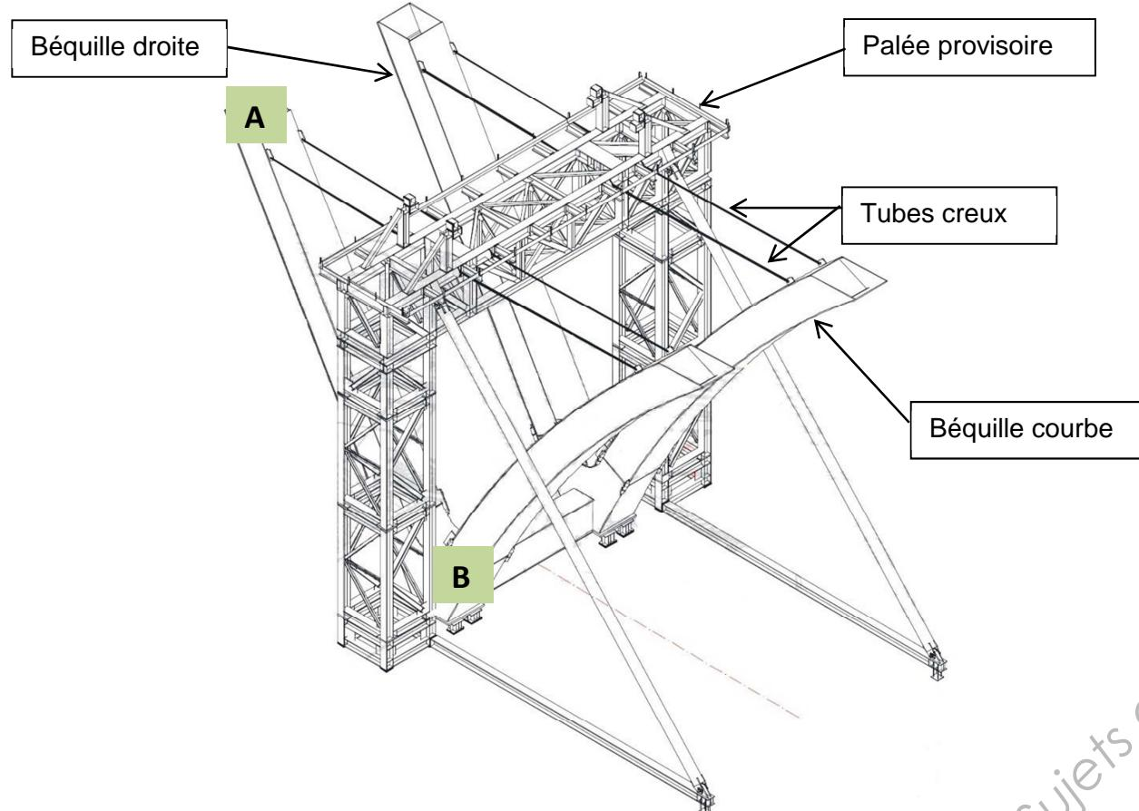
Les bêquilles (droite et courbe) sont des profils en acier (poids volumique de l'acier  $\gamma = 78,5 \text{ kN/m}^3$ ) dont la section a la forme d'un caisson.
