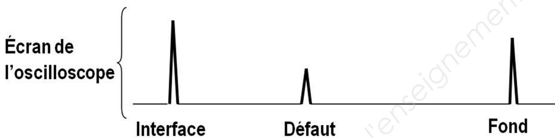
Le contrôle par ultrasons est basé sur la transmission et la réflexion d'ondes de type ultrasons à l'intérieur d'un matériau.
