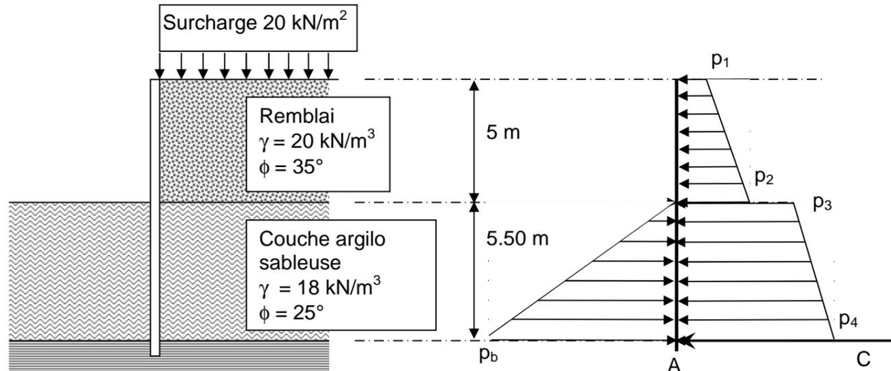
Le coefficient de poussée des terres ( $K_a$ ) peut être déterminé à partir de la formule suivante :
