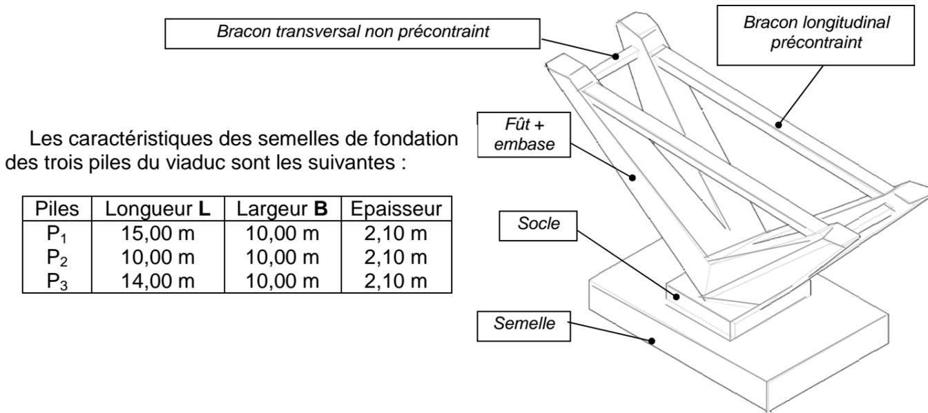
Les caractéristiques des semelles de fondation des trois piles du viaduc sont les suivantes :
